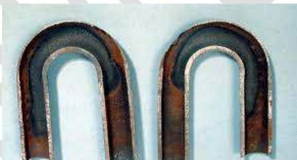
Afbeelding 10-4 Erosie corrosie Bron: Studiekern corrosie
