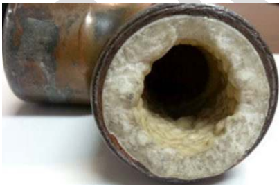
Afbeelding 9-1 Ketelsteen in verdamperpijp Bron: All Pro Plumbing, Inc.
